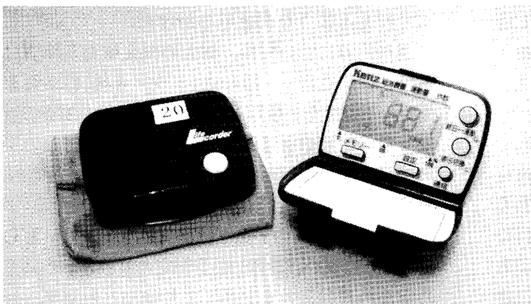
図2 ライフコーダ(生活習慣記録機)の外観図 左下の布製の袋にライフコーダを挿入し袋ごと腰部に装着した。
